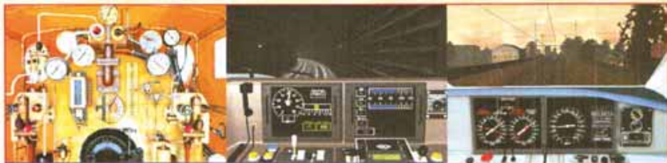
приборные панели парового, дизельного и электрического поездов, несмотря на внешне различие, построены по одной общей схеме: реверс — тяга — тормоз.
