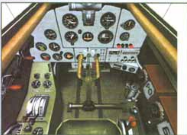
Кабинка летчика Ил-2. Горят сигнальные лампочки шасси (убрано). Все выглядит точно так, как на картинке из инструкции по эксплуатации для летчиков.
